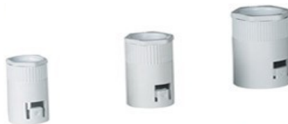
بوشن بین دار پی وی سی - اتصال لوله فلکسیبیل به سینی کابل، تراکینگ، انواع چراغ، فن کوئل، کولر و انواع جعبه تقسیم
